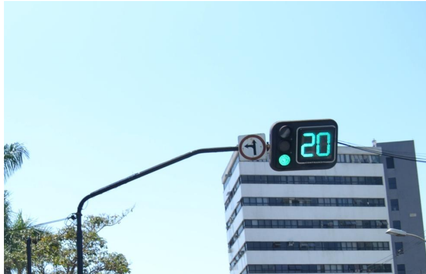
Figura 17: Sinalização semafórica com temporizador
